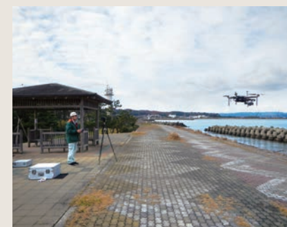
UAV写真測量
