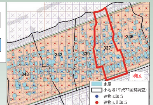
図2 ポイントサンプリング調査図面例 4)
