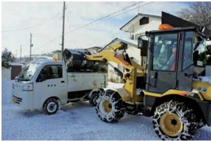
写真6 集積してできた堆雪をローダーで市が貸与した軽トラックに積み込む（上ノ山団地）
