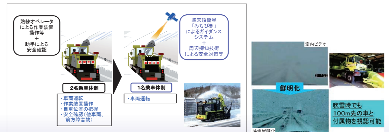
図8 投雪作業の自動化のイメージと、実証実験
