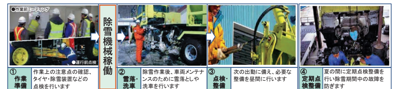
図7 除雪機械の運行管理や点検整備
