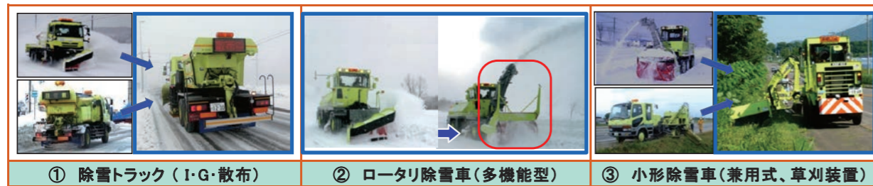
図3 除雪機械の多機能化や兼用化 (I:スノーブラウ、G:路面整正装置)
