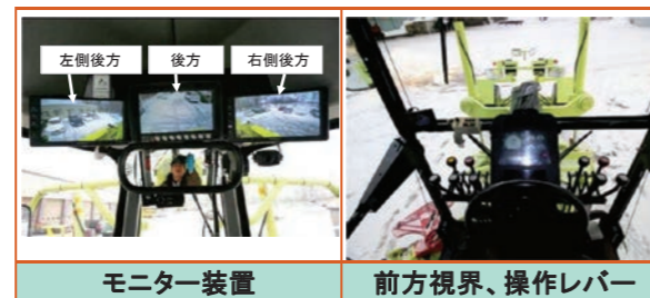
図4 ワンマン除雪グレーダの運転室
