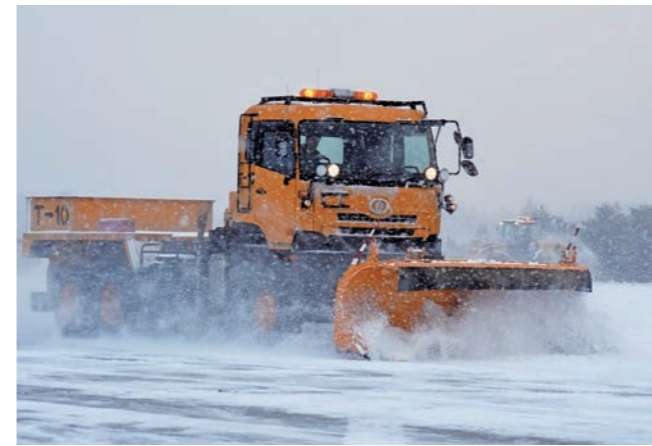
プラウ部分が中央を軸に稼働するアングリングタイプのスノープラウ
