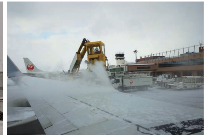
出発前に再度ディアイシング、アンチアイシングを行う。1台の車両にタイプ1とタイプ4両方のADFが積載されており、操縦席にて容易に切替可能となっている
