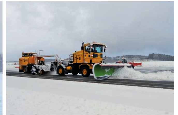
全長20m程で小回りは利かないが1台で2台分の作業をする空港独自のプラウ付スノーバー
