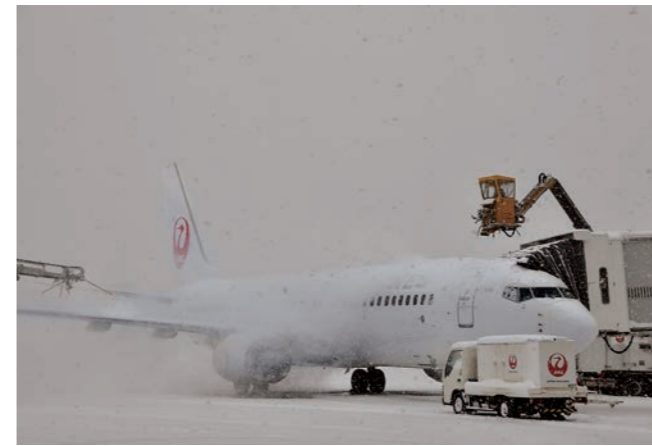
積もった雪や氷を融かすディアイシング。2台のディアイシングカーを使用して作業
