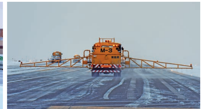
羽状装置を広げると15m程になる液体専用薬剤散布車
