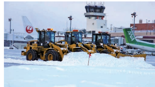
エプロンや取付誘導路で行われる複数台並走での除雪
