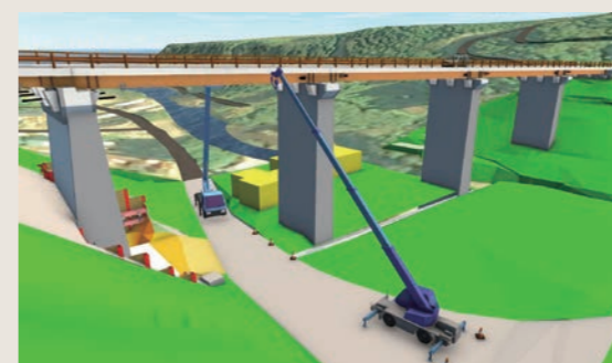
耐震補強工事3D施工計画
