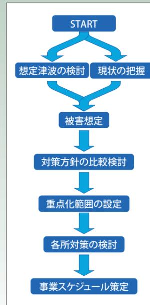
図4 耐津波対策検討作業フロー
