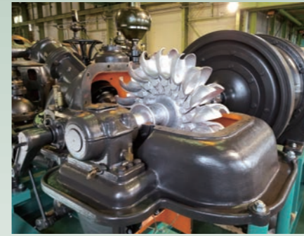
工場で修繕を終えた旧ペルトン水車
