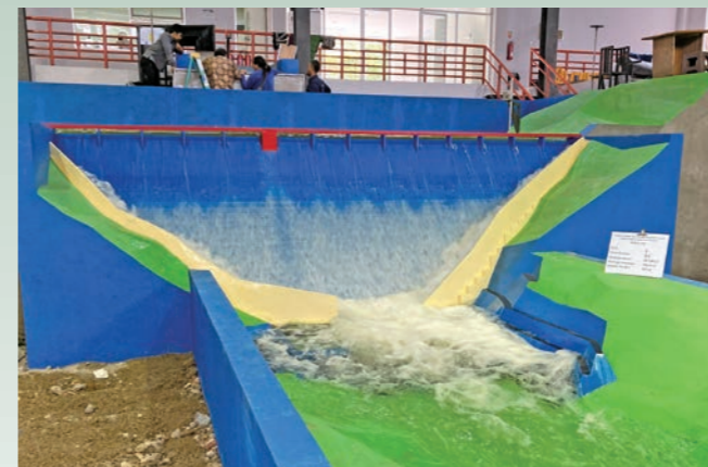
図6 下部ダム階段式洪水吐の水理実験
