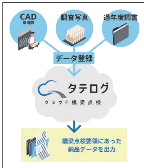
図2 タテログを使った点検調査作成のワークフロー
