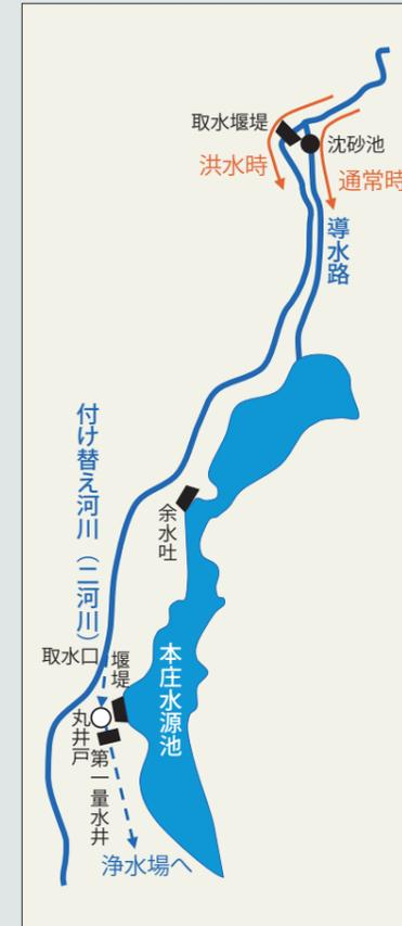
図2 付け替え河川(二河川)と配水系統図
