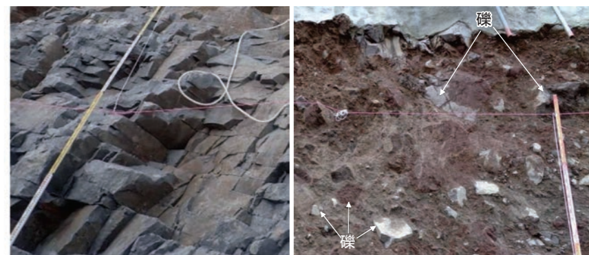
Pamは亀裂性岩盤で、冷却節理が発達している Paaは礫質岩盤で基質と礫から成る 写真2 先阿蘇火山岩類（Pam、Paa）掘削面
