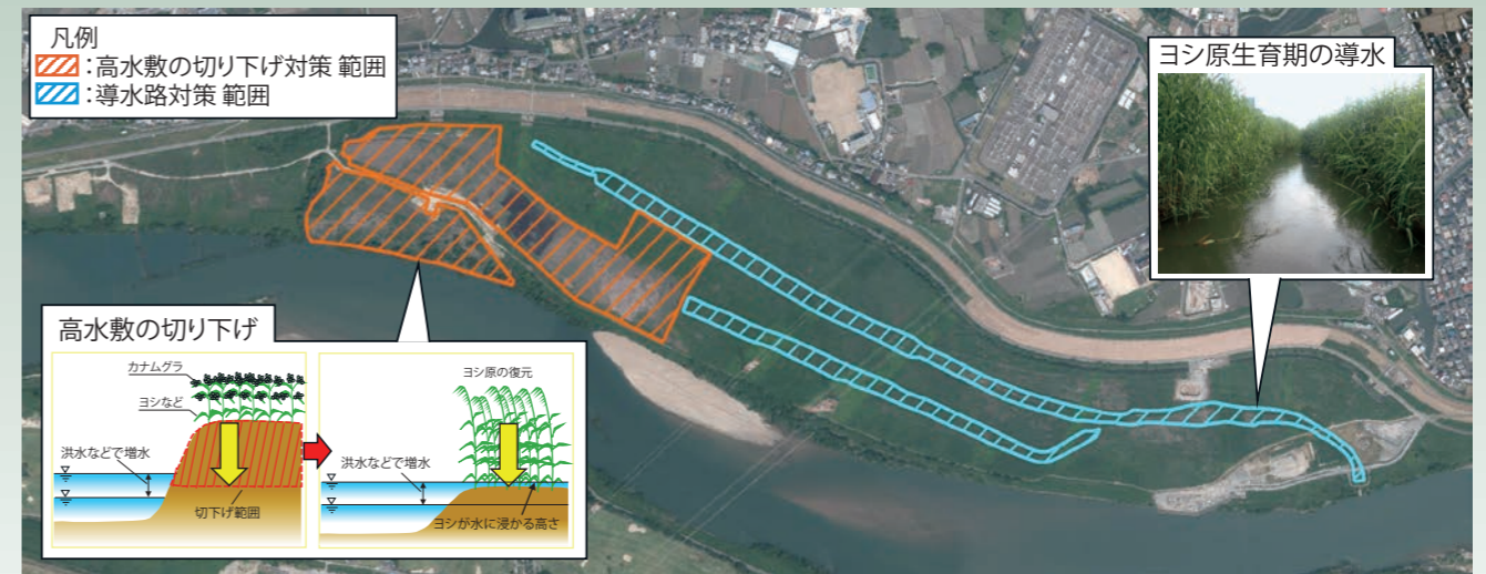
図2 整備事業の内容（鶴殿のヨシ原）（淀川総合水系環境整備事業【再評価】資料（近畿地方整備局、令和6年11月）を基に筆者作成）
