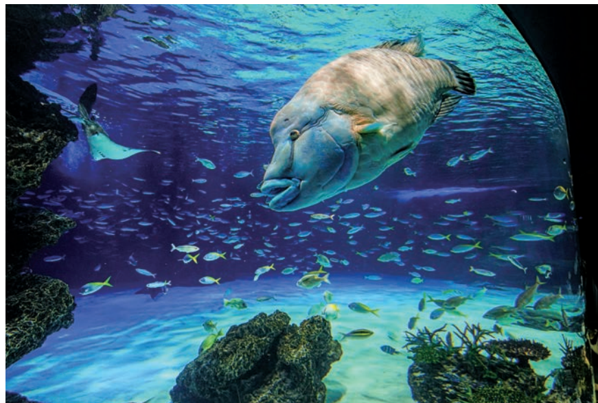
写真1 水槽の形状で隅を隠し、水槽での水平照明効果、アクリル局面による錯視、遠近法による錯視などにより小規模大水槽を海に見せている水塊／サンシャインラグーン水槽：サンシャイン水族館
