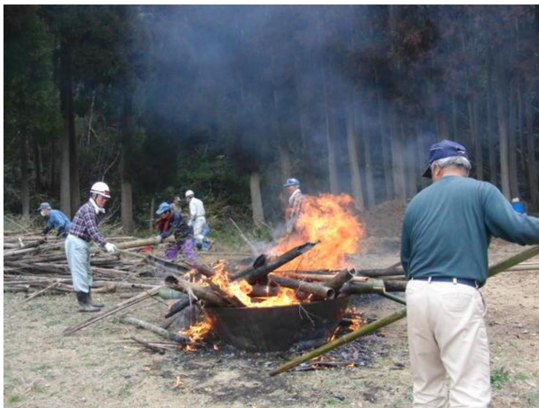
写真一1 無煙炭化機による竹炭づくり
